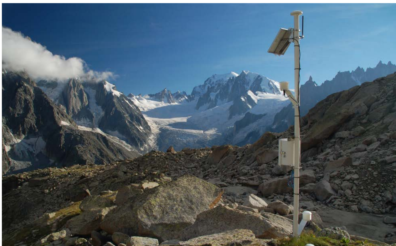
Station de mesure de température du CREA au Couvercle (Massif du Mont-Blanc 2 700 m) © CREA Mont-Blanc
